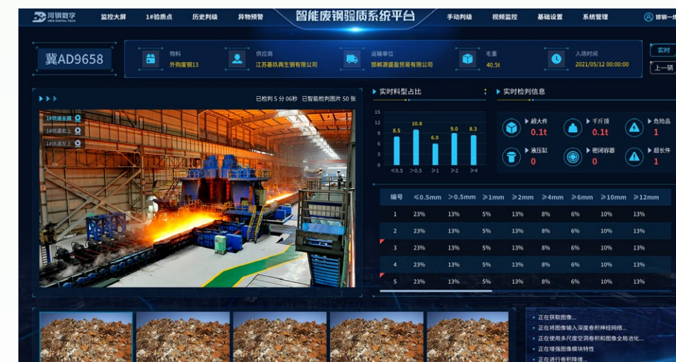
自主研发全流程、自动化、智能化的 AI 废钢验质系统，实现从人工现场判级到远程智能判级的跨越，加强废钢综合利用
